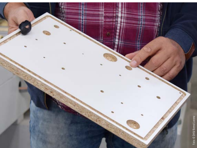
Das Bohrbild der CNC-Maschine. Die Löcher verteilen sich auf einem gleichmäßigen Raster von 50 mal 50 Millimetern.
